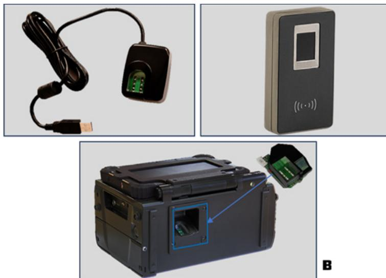
Рисунок 1. – Внешний вид сканеров отпечатков пальцев аппаратно-программных комплексов ООО «Регула»
